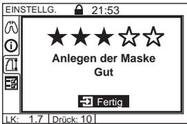
Außerdem wird auf dem LCD-Display eine Sternchenklassifizierung (0 bis 5 Sterne) zum Maskensitz angezeigt. Drei bis fünf Sterne deuten auf einen guten Sitz hin. Bei einer Anzeige von null bis zwei Sternen sollten Sie den Maskensitz korrigieren.
