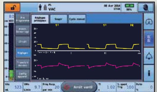
Les courbes de pression et de débit et les paramètres essentiels sont affichés en temps réel sur l'écran tactile couleur.
