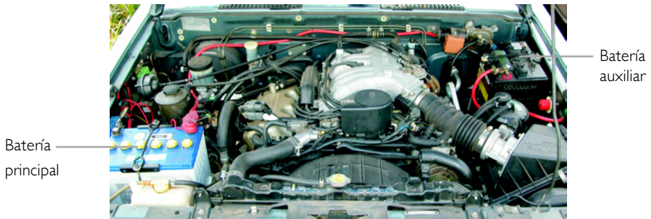
Doble instalación de batería
