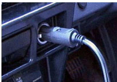
Conexión al enchufe del encendedor de cigarrillos
